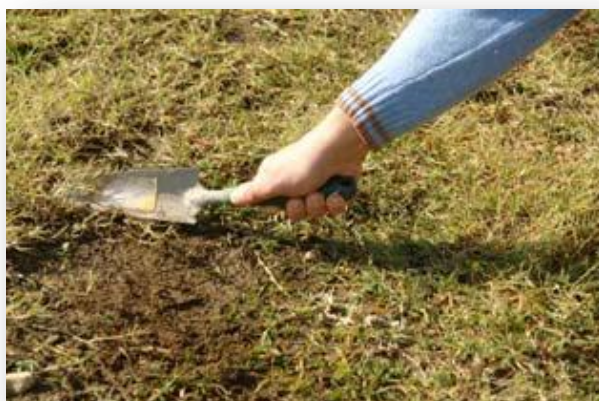
Φωτογραφία 1. Επιφανειακός καθαρισμός σημείου δειγματοληψίας.
