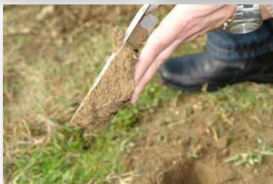
Φωτογραφίες 1-4. Δειγματοληψία επιφανειακού δείγματος (0-10 εκ.)
