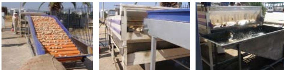
Εικόνα 6. Η εγκατάσταση πλυσίματος και βουρτσίσματος πατατοσπόρου.
