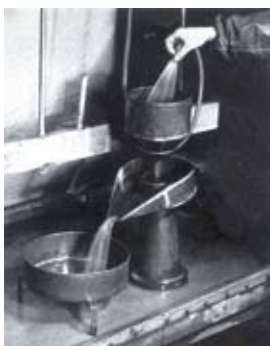
Εικόνα 1. Η συσκευή Fenwick που χρησιμο-ποιείται για την εξαγωγή κύστεων από εδα-φικά δείγματα > 500γρ.
