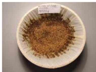
Εικόνα 4. Χαρτομάντηλο σε πλέγμα υποστή-ριξης, φέρον το προϊόν απομόνωσης κύστεων με τη συσκευή Fenwick.
